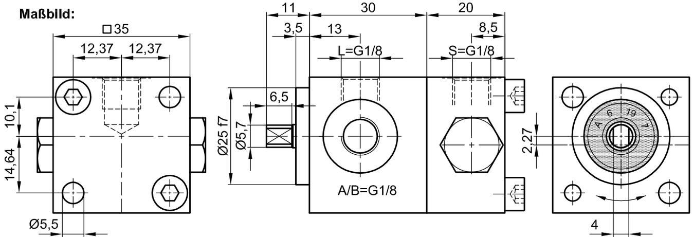
Befestigung: DIN 912-M5x60-8:8 Anzugsmoment: 8 Nm
