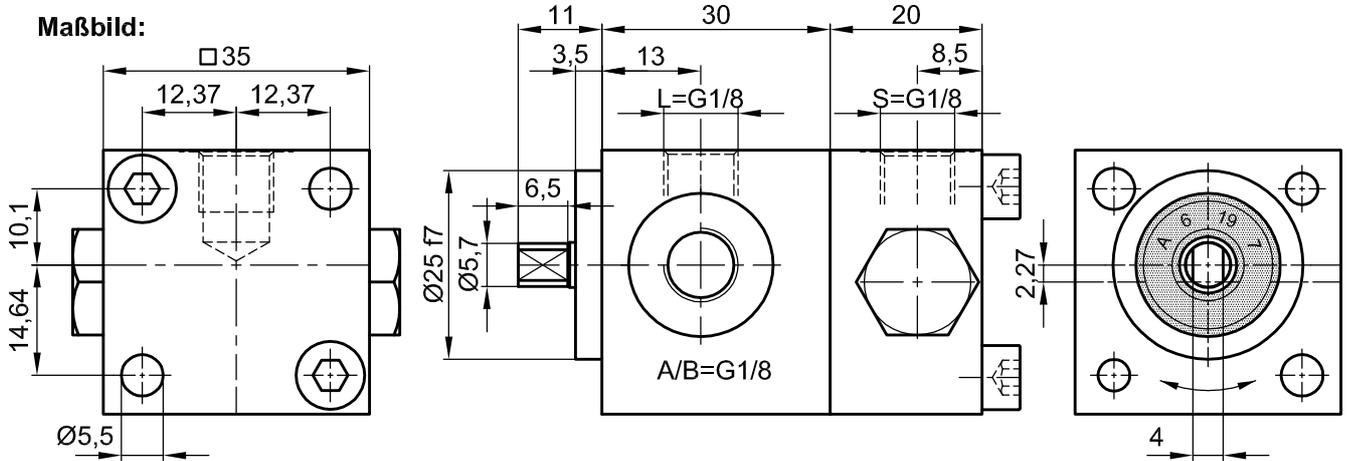
Befestigung: DIN 912-M5x60-8:8 Anzugsmoment: 8 Nm
