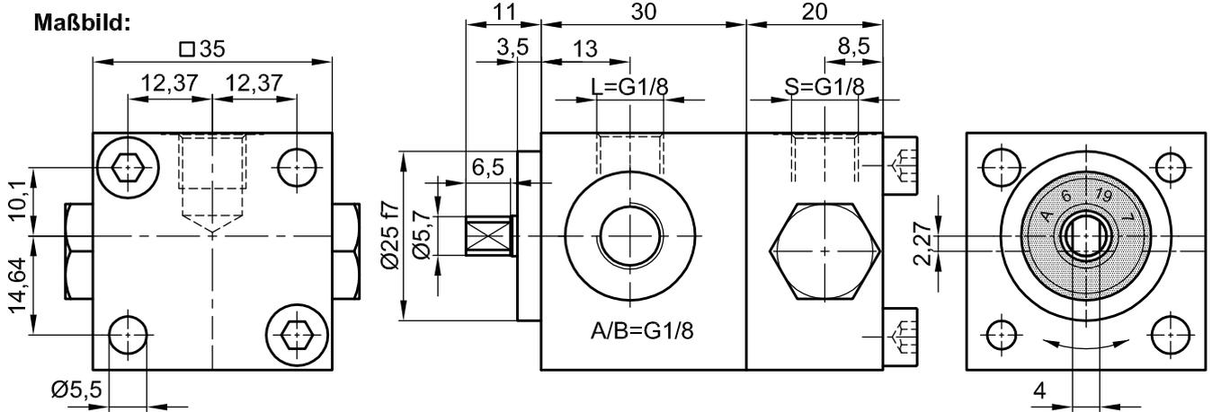
Befestigung: DIN 912-M5x60-8:8 Anzugsmoment: 8 Nm
